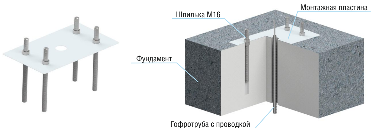
Рисунок 7.2.1 Устройство фундамента с монтажным комплектом
