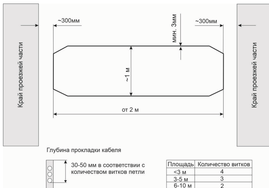
Рисунок 6.9.2.2 Схема монтажа петли
